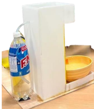
GAMBARAJAH 11. Projek Dispenser Wuduk Automatik Menggunakan ESP32
